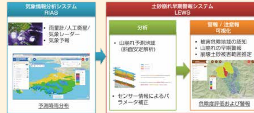
気象情報分析システムによる予測降雨を用いた土砂崩れ早期警報システム
