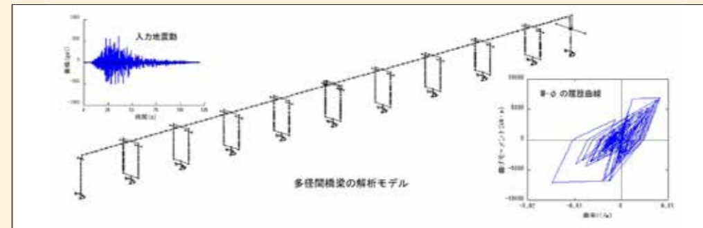
解析モデルおよび部材断面力の履歴曲線
