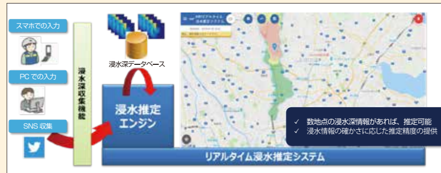
ベイズ法・最適内挿法によるデータ同化技術を用いた浸水想定システム
