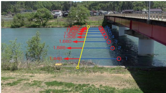
Hydro-STIVとは、映像と水位情報を用いて流速・流量を計測するシステムです。
