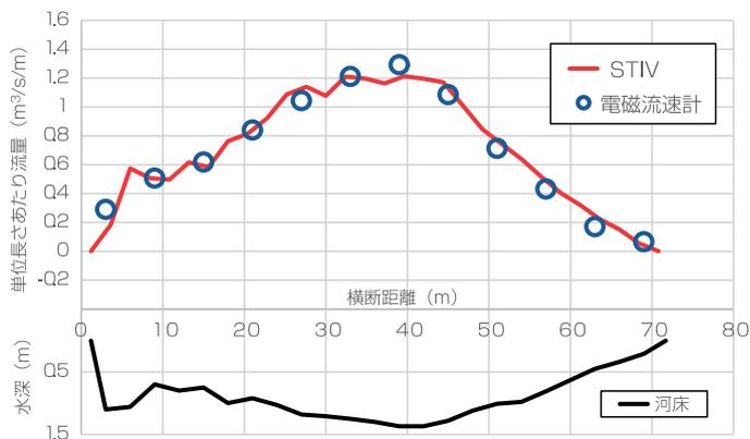
電磁流速計と同等の計測精度
